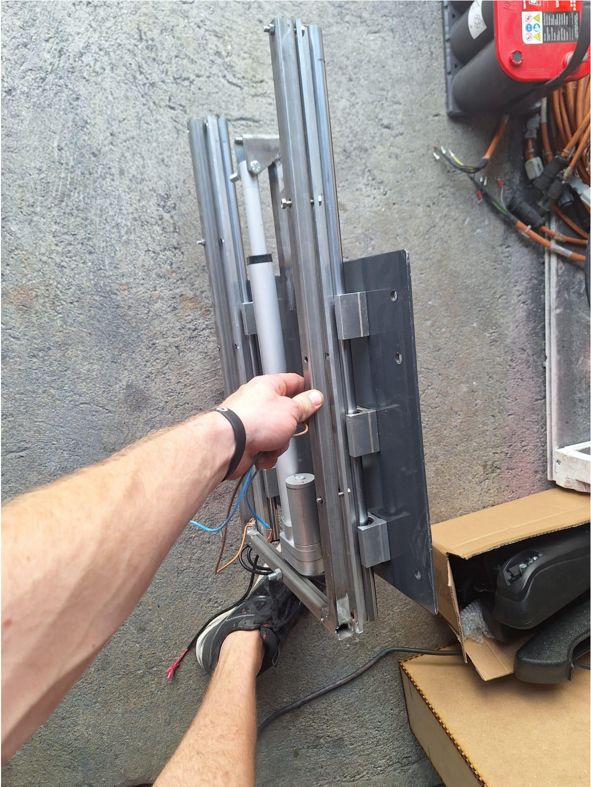
Linearantrieb zur Bewegung der Cockpitsitze
